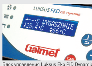
Блок управления Luksus Eko PiD Dynamic
