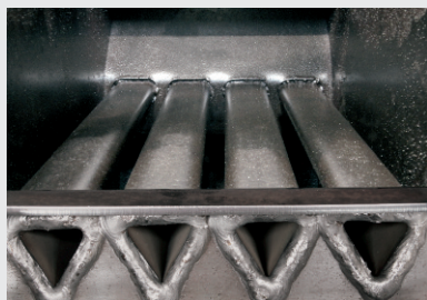
Стационарный стальной теплообменник-решетка
