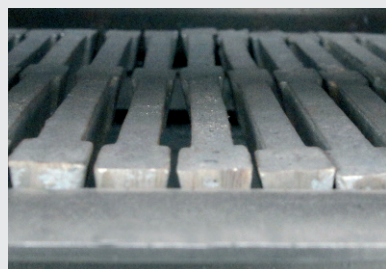
Секционная чугунная топочная решетка
