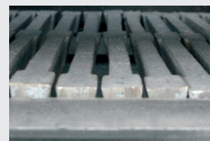
Секционная чугунная топочная решетка
