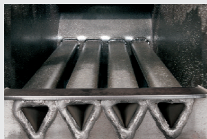
Теплообменная стальная точечная решетка
