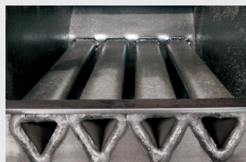
Стационарная теплообменная стальная топочная решетка
