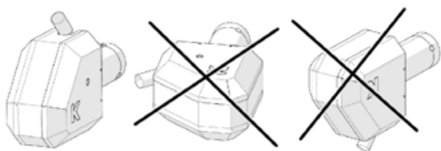
Rys: Sposób montażu palnika
