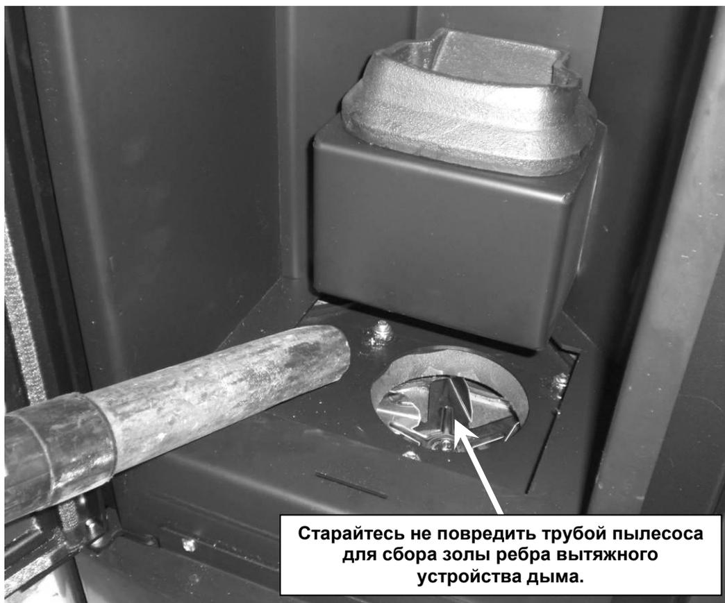
**Старайтесь не повредить трубой пылесоса для сбора золы ребра вытяжного устройства дыма.**
