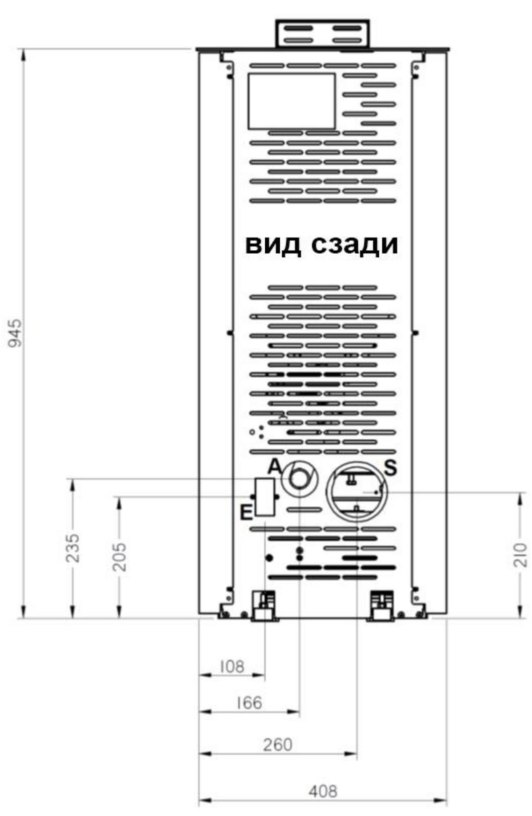
**S** = ОТВОД ДЫМА Ø 80 мм М
