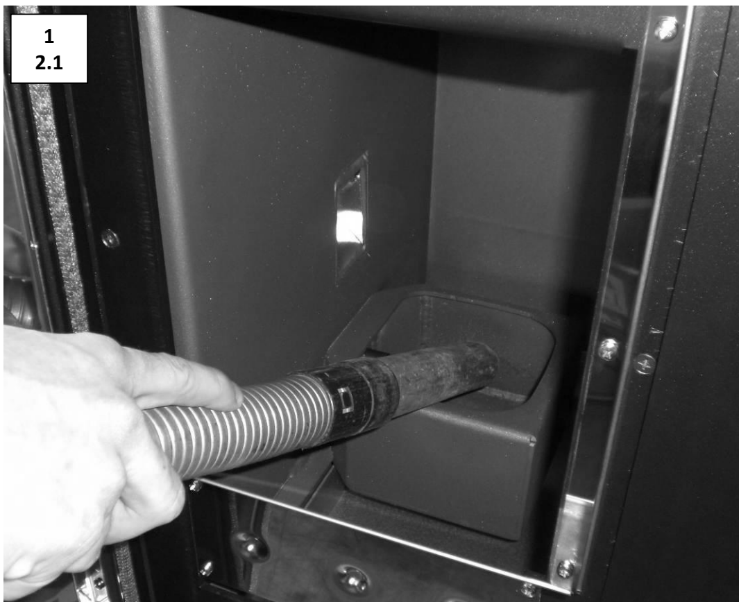
С помощью пылесоса удалить золу под горелкой.
