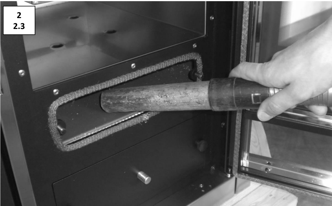
Демонтировать патрубок под печью и удалить отложения золы под и сбоку от него. После чистки установить на место патрубок, обращая внимание, чтобы он не пропускал дым.
