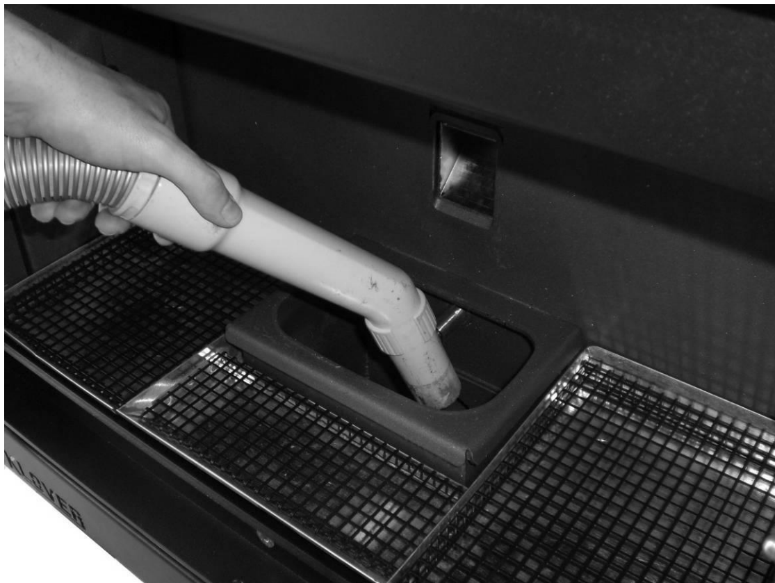
С помощью пылесоса удалить золу под горелкой.
