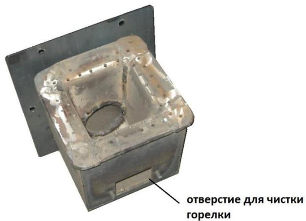
*Рисунок 11 – Отверстие для чистки горелки.*
