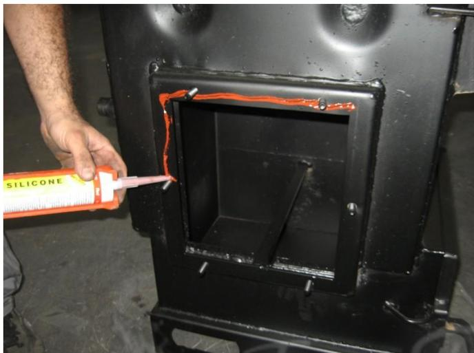
Рисунок 15 – Нанесение жаростойкого силикона перед установкой прокладки.
