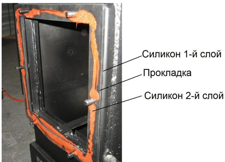
Рисунок 16 – Установка прокладки на силикон и нанесение второго слоя.
