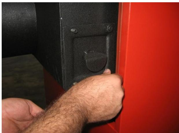
Рисунок 9 – Снятие заглушки для чистки адаптера дыма
